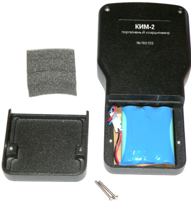
Рис. 1-3. Прибор со снятой крышкой аккумуляторного отсека
